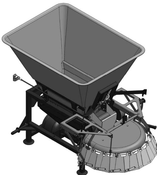
Rys. 12. Rozsiewacz nawozów N031M/1 z przystawką komunalną.
