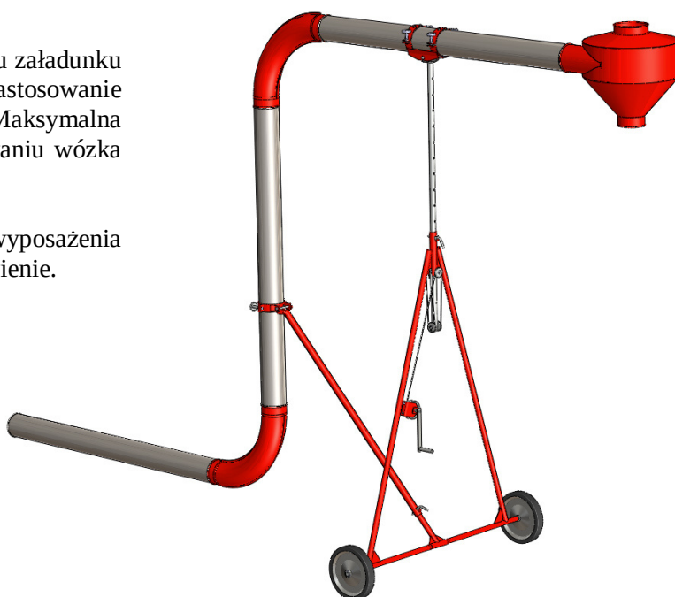
Rys. 4. Rurociąg transportowy, ustawiony na wózku podporowym, przygotowany do załadunku.
