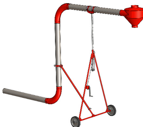
Rys. 4. Ustawienie rurociągu transportowego na wózku podporowym.
