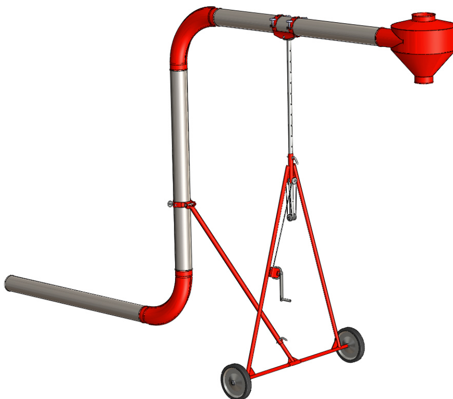
Rys. 3. Rurociąg transportowy, ustawiony na wózku podporowym, przygotowany do załadunku.
