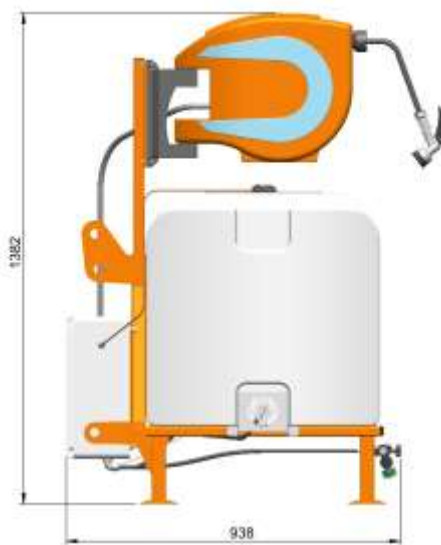
Rys. 3. Orientacyjne wymiary zraszacza (długość, wysokość)
